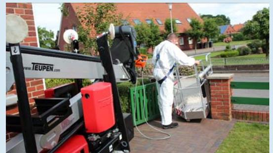
Zum Passieren enger Zugänge ist der Arbeitskorb abnehmbar. Er wird dann auf darunter liegenden Rollen transportiert.
