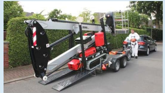
Der leichte LEO15GT kann auf Standardanhängern transportiert werden. Mit der Kabelfernbedienung ist Be- und Entladen schnell und einfach.
