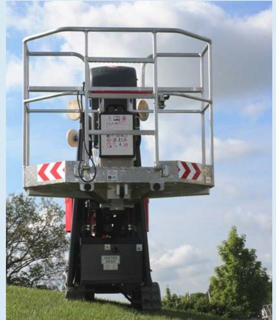
Das optionale verstellbare Kettenfahrwerk verschafft mehr Bodenfreiheit und erlaubt das sichere Fahren an Hängen.
